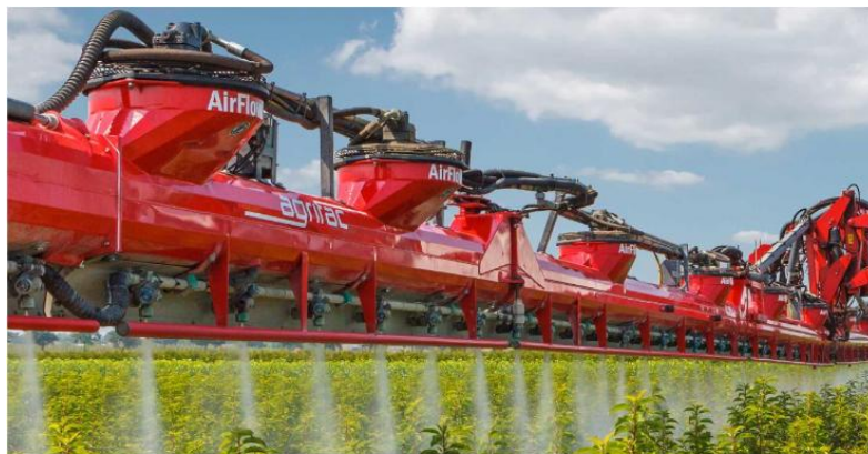
Exemple d'un pulvérisateur à assistance d'air. © Agrifac.
